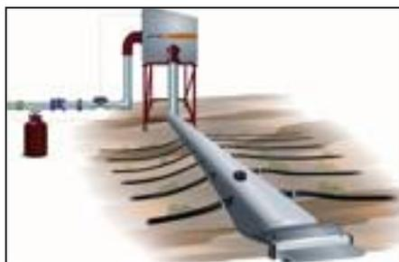
**U**na delle più recenti innovazioni per l'irrigazione a goccia viene proposta da Netafim che ha realizzato un nuovo sistema di irrigazione a bassissima pressione Lps (Low Pressure System - Sistema di irrigazione a bassa pressione) che si propone di risolvere le problematiche relative all'irrigazione in pieno campo.
